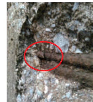
鉄筋腐食 サンプル写真 2020年 サビによる体積膨張、割れも見られる 拓南製鉄(株)中城工場 暴露写真(25年目写真)
